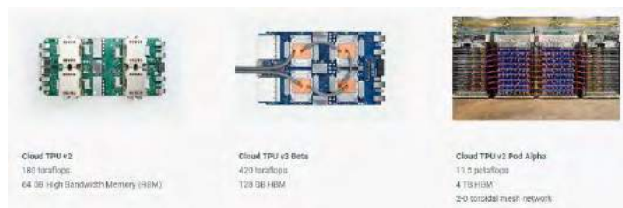
Fig. 6. Cloud TPU v2 Pod Alfa 11.5 petaflops 4 TB de HBM. Red en malla toroidal 2-D. [9]
