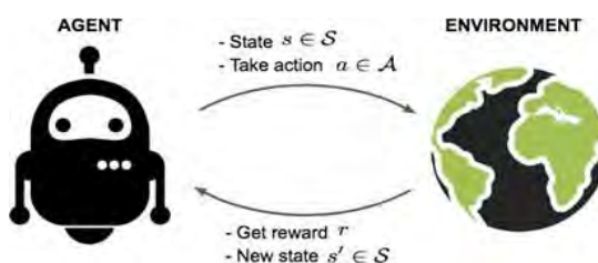
Fig. 5. Diagrama básico de aprendizaje de un agente mediante aprendizaje reforzado [8]
